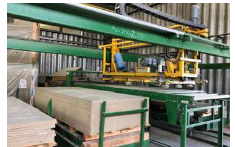
Die gelieferten Flachpressplatten werden genau vermessen und gewogen
