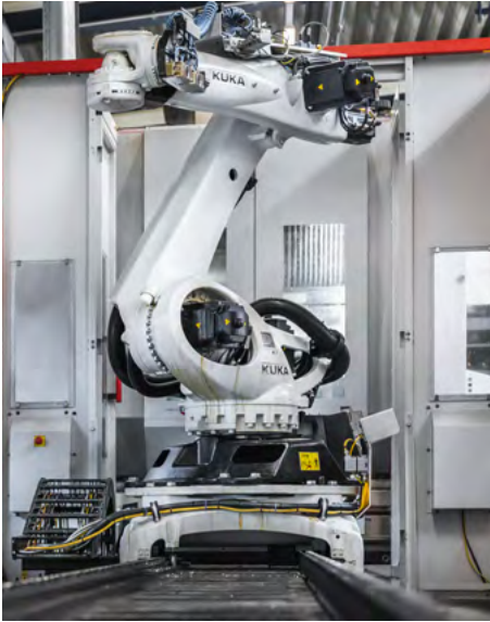
Verfahrbarer Roboter zur Bestückung von Bearbeitungszentren. RWT zeigt den Weg zur Industrie 4.0.
